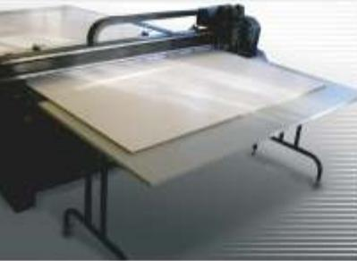
Las robustas mesas extensoras pueden colocarse frente y detrás de la mesa, y se pueden ajustar a la altura correcta. Así, puede procesarse material en plancha, de longitud muy superior a la de la mesa, en combinación con el sistema transportador. Las mesas pueden utilizarse también para depositar el siguiente trabajo en la cola y para post-procesar el trabajo anterior. Cuando no
