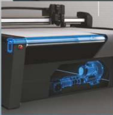
Mesa de vacío con selector de vacío & bomba de vacío, Sistema de absorción de sonido y Válvula de Conmutación
